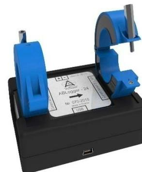
Ниже, пример использования прибора для контроля за состоянием АКБ погрузчика в различных режимах, включая «заряд», что позволяет оценить работу как самой батареи, так и зарядного устройства. Графики основных электрических параметров, полученных с помощью прибора ABLogger, отражают значения тока, напряжения и емкости, полученной и отданной АКБ в различных эксплуатационных режимах, что в значительной степени дополняет техническое обследование.
