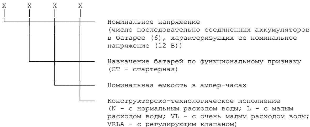
Пример условного обозначения батарей, состоящих из шести аккумуляторов номинальной емкостью 55 А х ч, с нормальным расходом воды N, поставляемых в готовом для работы состоянии (залитых электролитом и заряженных):
