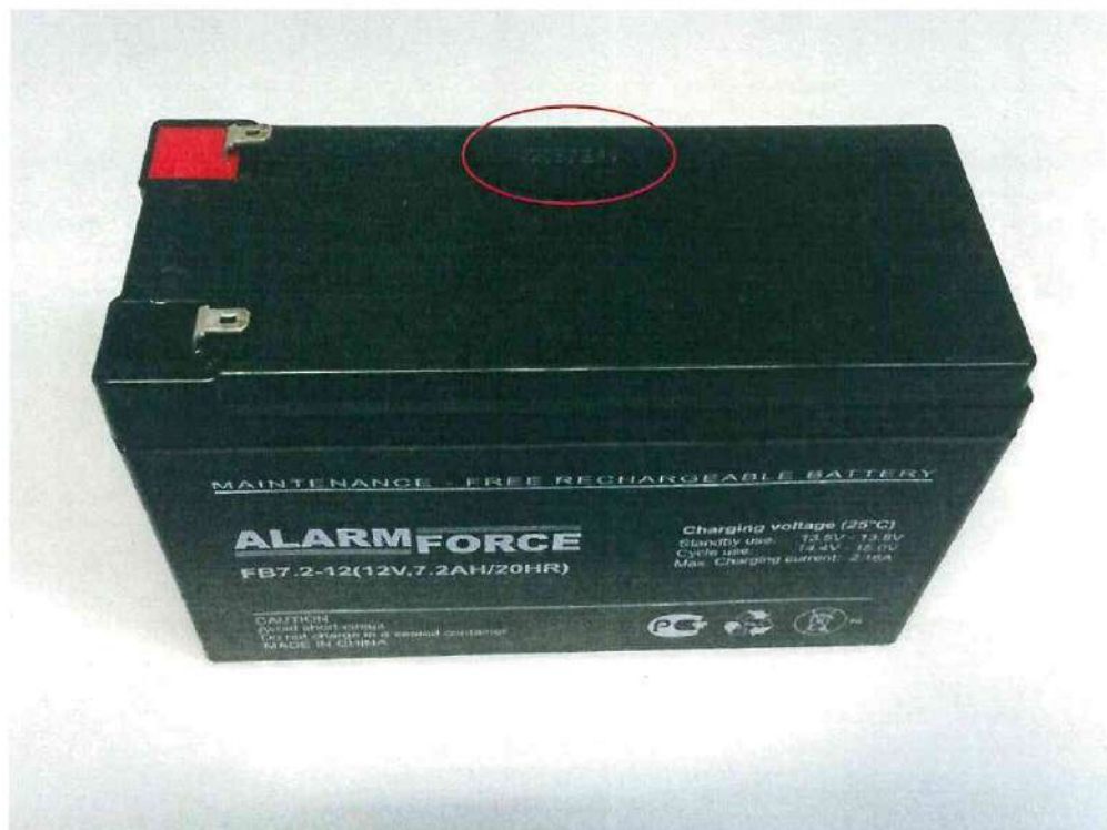
Рисунок 5 – неразборчивое обозначение даты изготовления
